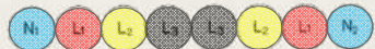
شکل ۱۳-۷-۱-۱: آرایش چسبیده به هم و هم‌تراز برای ۶ رشته کابل تک‌رشته موازی (سه‌فاز)
