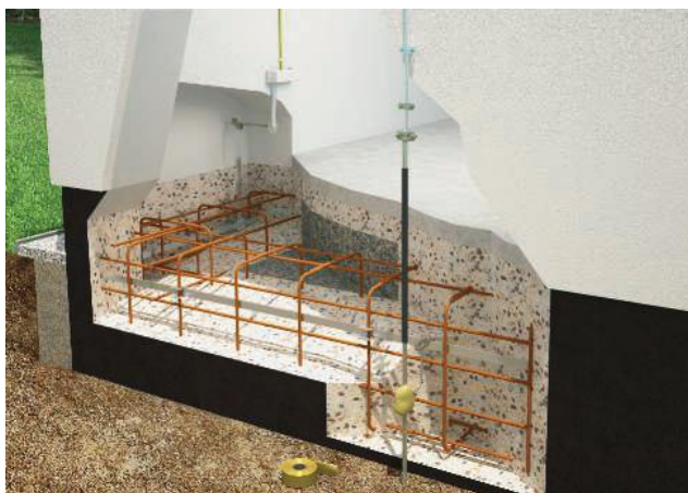
شکل (۲-۱۱): الکتروود مدفون در بتن
